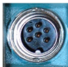
Разъем 6-ти пин. НЧ, СЧ. Вид с тыльной стороны (Рис. 3)
