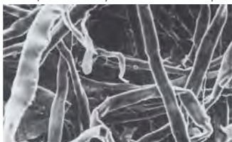
Рис. Верхняя поверхность фильтрующего элемента: увеличение в 15 раз
