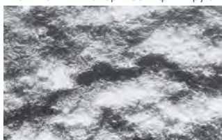
Рис. Внешняя поверхность фильтрующего элемента: увеличение в 15 раз
